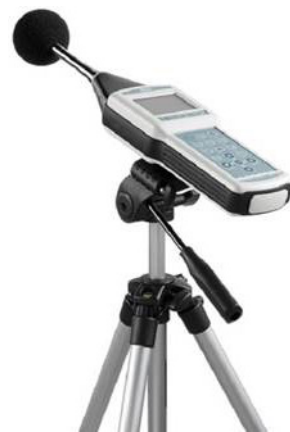
Sonômetro utilizado para o monitoramento do ruído
