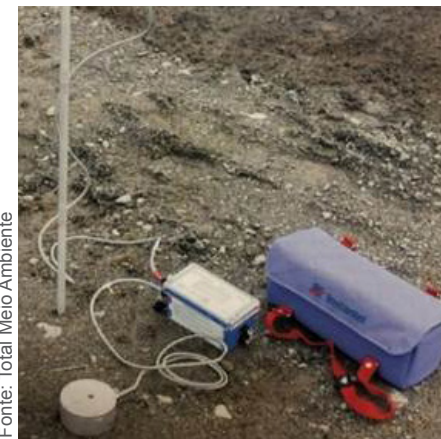
Sismógrafo utilizado para o monitoramento do vibração
